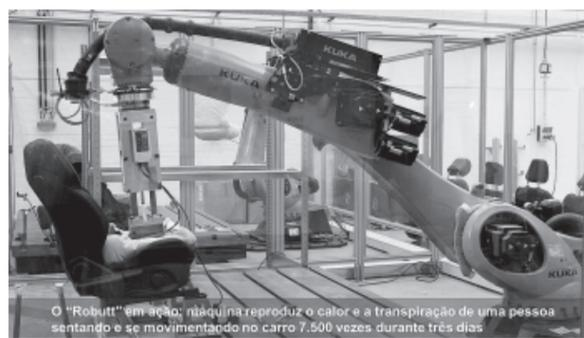
**O “Robutt” em ação: máquina reproduz o calor e a transpiração de uma pessoa sentando e se movimentando no carro 7.500 vezes durante três dias**
